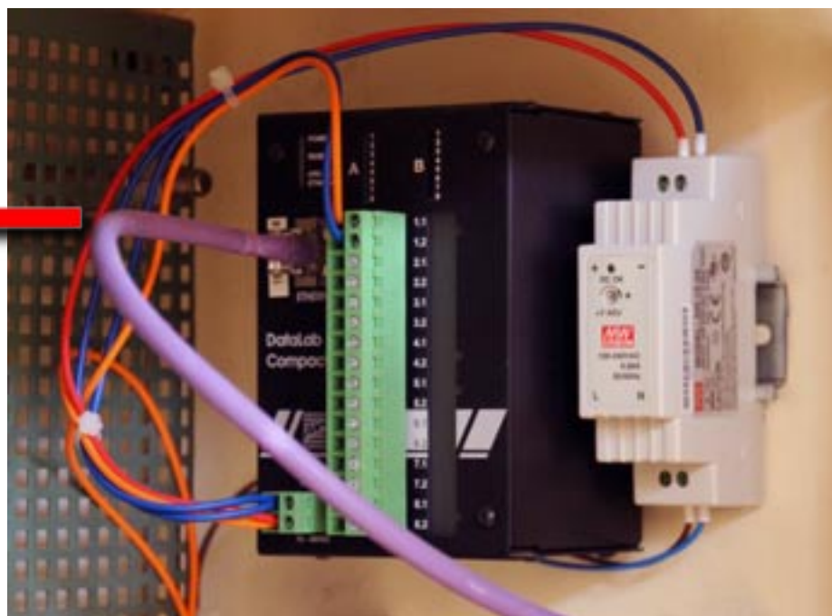
... a pomocí ethernetové přípojky se stroj zařadí do TCP/IP komunikační sítě
